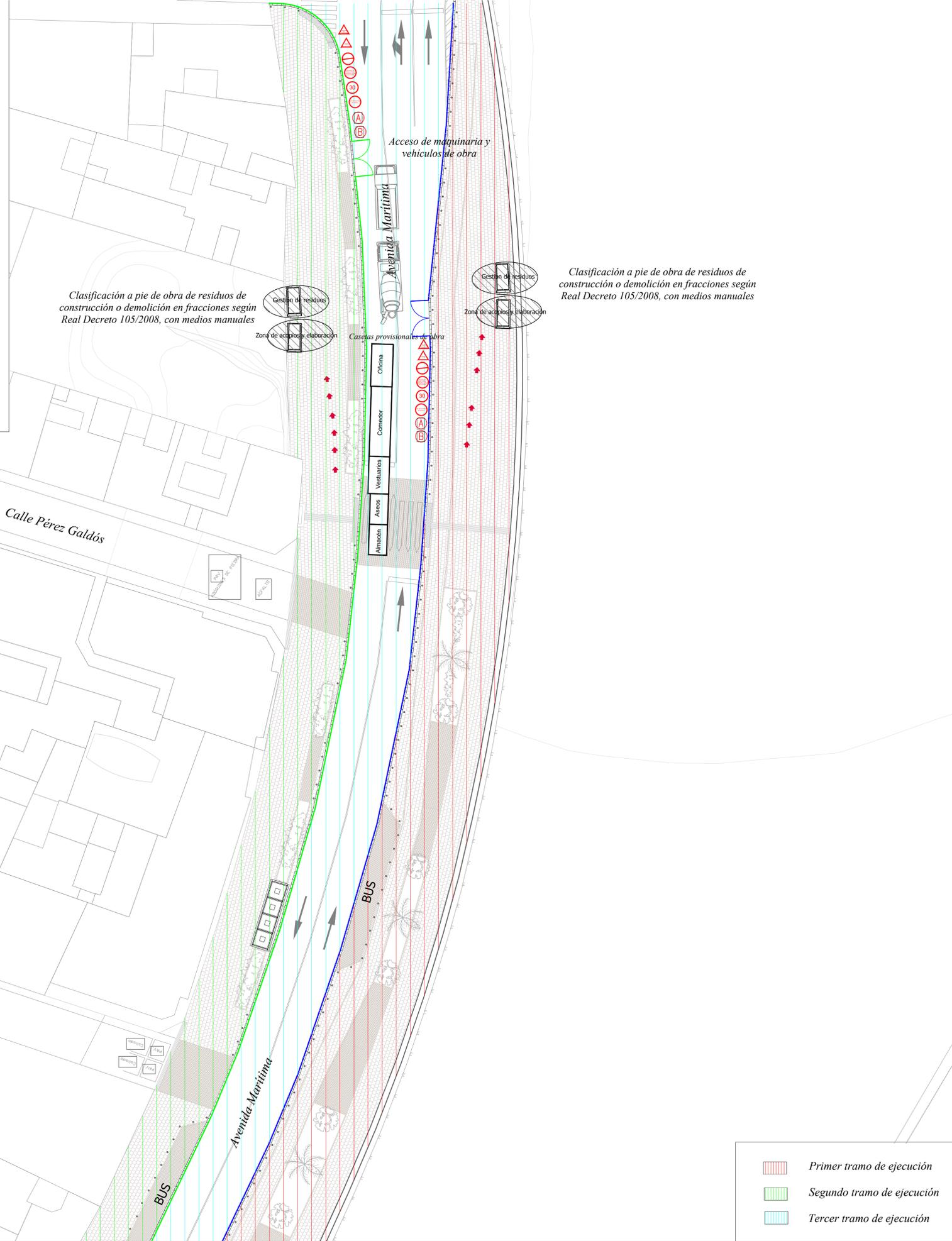
Clasificación a pie de obra de residuos de construcción o demolición en fracciones según Real Decreto 105/2008, con medios manuales
