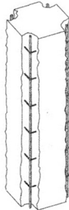
3. Desoxidación y protección de armaduras
