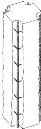
3. Desoxidación y protección de armaduras
